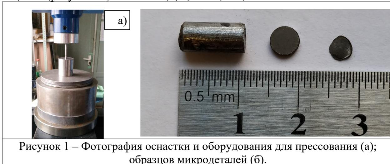
Рисунок 1 – Фотография оснастки и оборудования для прессования (а); образцов микродеталей (б).
