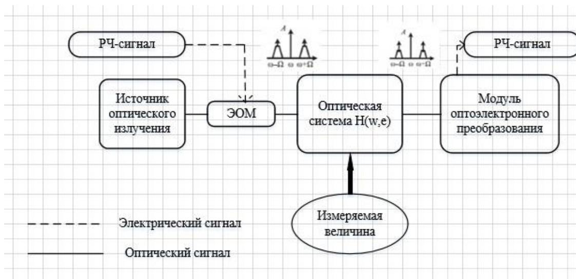
Рисунок 2 – Структурная схема радиофотонного волоконно–оптического измерительного прибора:  $A$  – амплитуда оптического сигнала;  $\omega$  – центральная частота оптического сигнала;  $\Omega$  – центральная частота РЧ-сигнала
