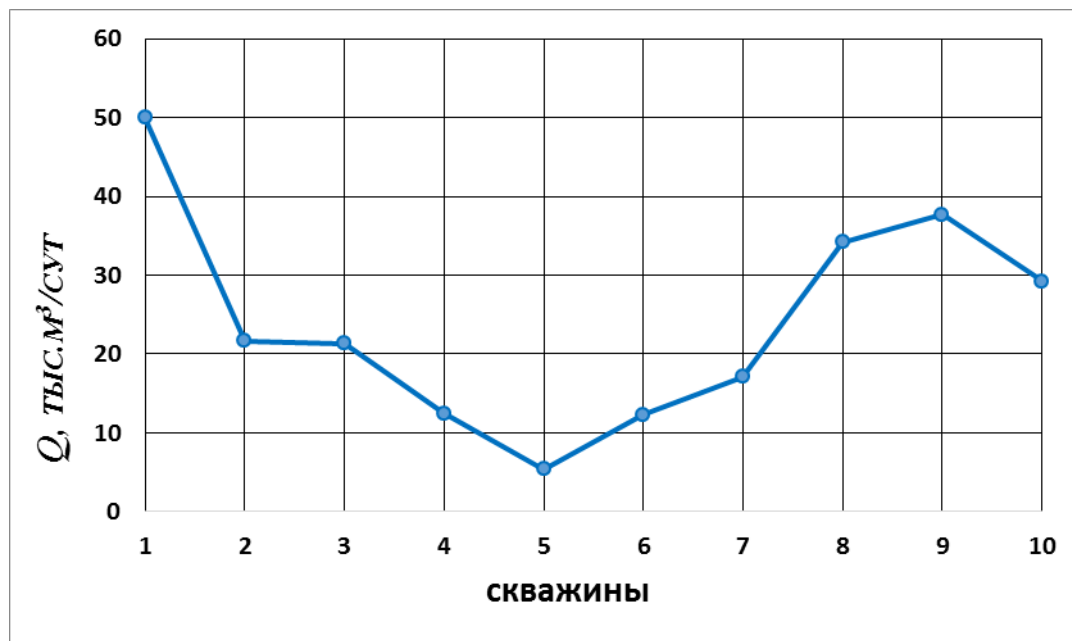
Рис.2 Распределение дебита газа по скважинам
