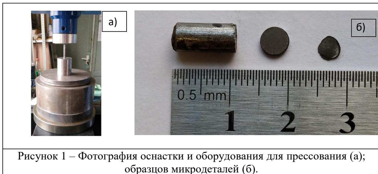
Рисунок 1 – Фотография оснастки и оборудования для прессования (а); образцов микродеталей (б).
